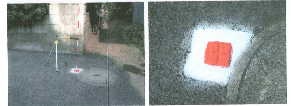
境界点番号 5 新設民間境界石標 国土調査成果により復元 平成16年7月6日埋設
