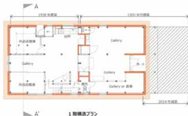
外周部を新たな在来軸組で囲った補強計画
