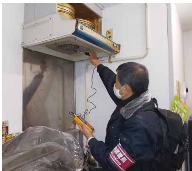
換気扇の風量調査（12条点検）
