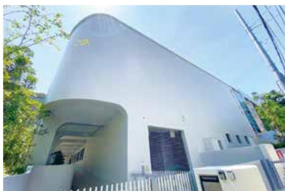
SGコートは光触媒だけでなく、フッ素やセラミックなど、様々な高防汚性塗料を展開しております。RCフラット仕上げには、クラック防止として「炭素繊維入りモルタル・SGマイティ」を、重ねて防汚コートとして「高耐候性水系セラミック塗料・SG-S」を施工しました。美しい仕上がりを長期間に渡り維持するためのコンビネーション施工です。建物の特徴や立地条件等に応じて最適な塗料をご提案させていただきます。屋根・外壁材と併せ、是非お気軽にご相談くださいませ。
