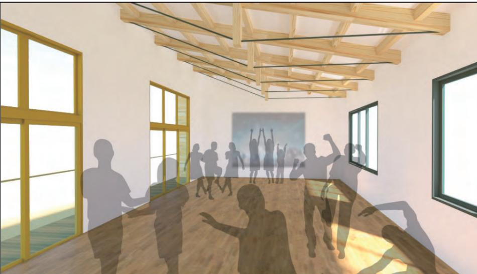
木造張弦トラスによる、無柱の開放的な集会室。床はダンスに適したフローリング仕上げとし、壁面は多用途に使用できるよう、シンプルな白色壁紙で仕上げます。
